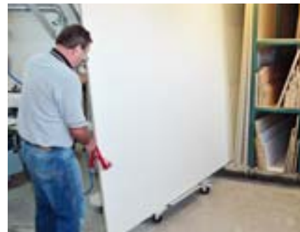
Anton Böhm zieht eine Platte mithilfe eines Handlinggerätes aus dem Regal ...
