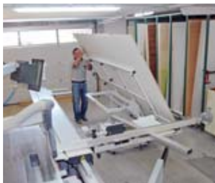
... und kippt es einfach auf den Sägetisch. Er braucht keinen zweiten Mann
