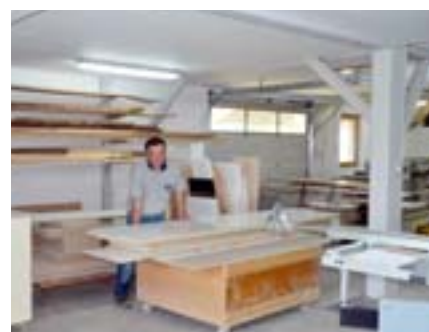
... nun fährt der Maschinenführer die Streifen zum Ablängen neben den Schlitten,...
